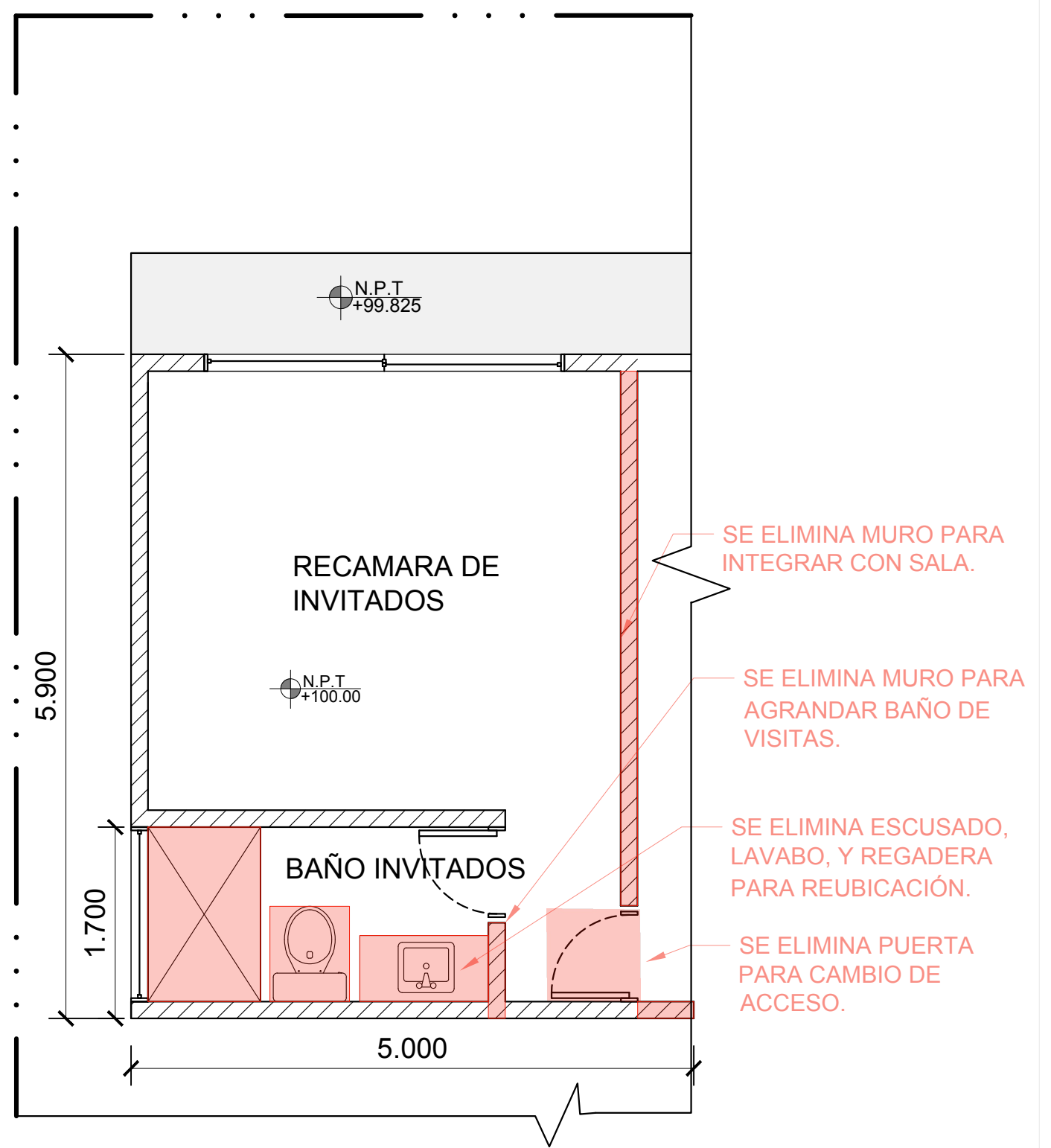
2 PLANO DE DEMOLICIONES ESCALA 1:75
