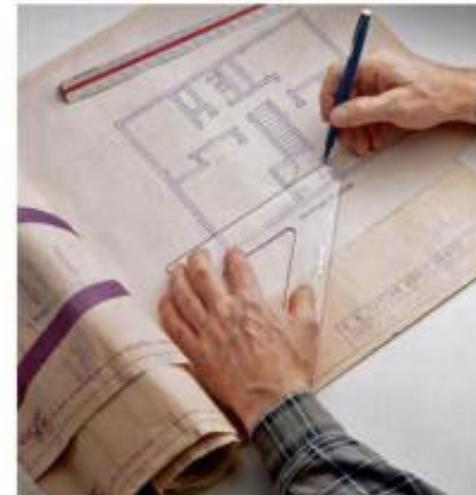
**Opción:** use planos de la casa para crear el plano de plomería. Pase los trazados generales de cada piso a papel calcante. Las paredes pueden ser dibujadas más grandes que la escala para que se ajusten a todos los símbolos de plomería que hará, pero mantenga a escala las dimensiones totales de las habitaciones y las instalaciones. Asegúrese de hacer también diagramas para los espacios del sótano y el desván.
